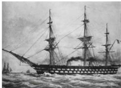
图2: 1849年, 法国建造了世界上第一艘以蒸汽机为主动力装置的战列舰“拿破仑”号, 它装配了100门火炮, 标志着蒸汽战列舰时代的到来, 但它仍挂有作为辅助动力的风帆。
