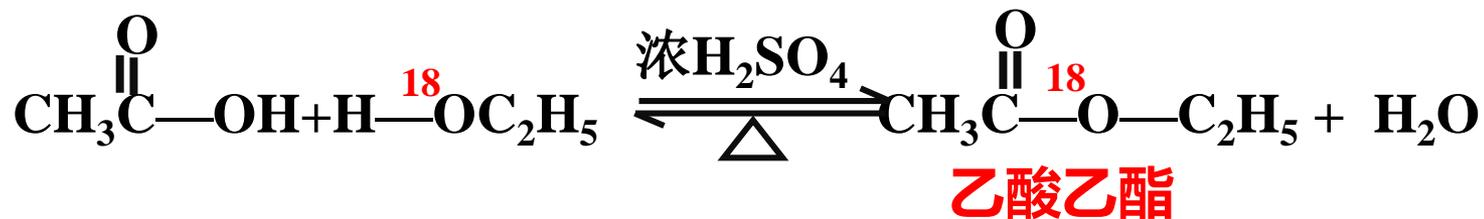
乙酸乙酯的制备及反应条件探究
